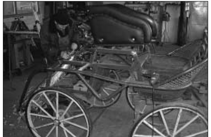
Ein Blick in die Werkstatt zeigt die Generalüberholung eines Marathonwagens
