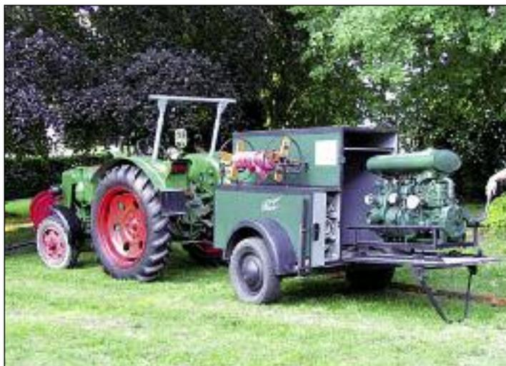
Mit dem Traktor zum Einsatz gezogen: die erste Motorspritze von 1937
