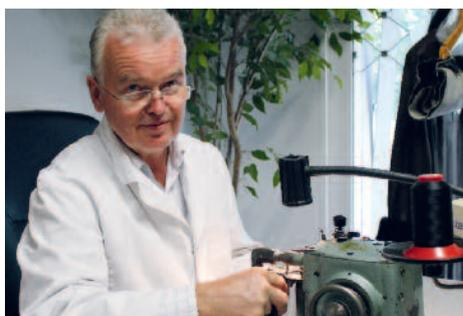
Bevor ein Kleidungsstück entstehen kann, müssen die schmalen Pelzstreifen mit einer speziellen Pelznähmaschine in akribischer Kleinarbeit zusammengenäht werden.
