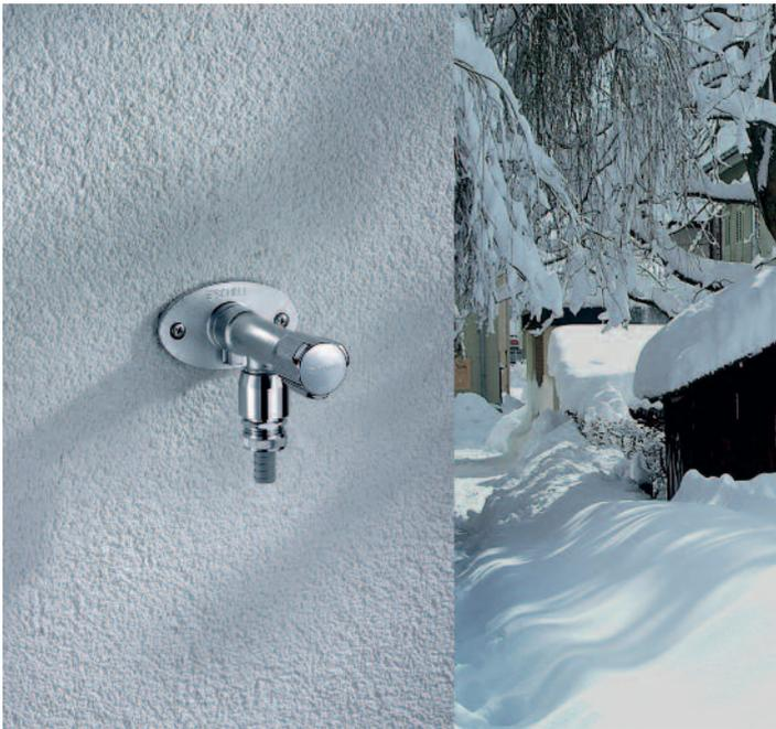
Raffinierte Technik schützt vor dem Zufrieren: Wird die Außenarmatur geschlossen, öffnet sich das innenliegende Belüftungsventil und entleert die gesamte Armatur automatisch. Foto: Schell/akz-o
